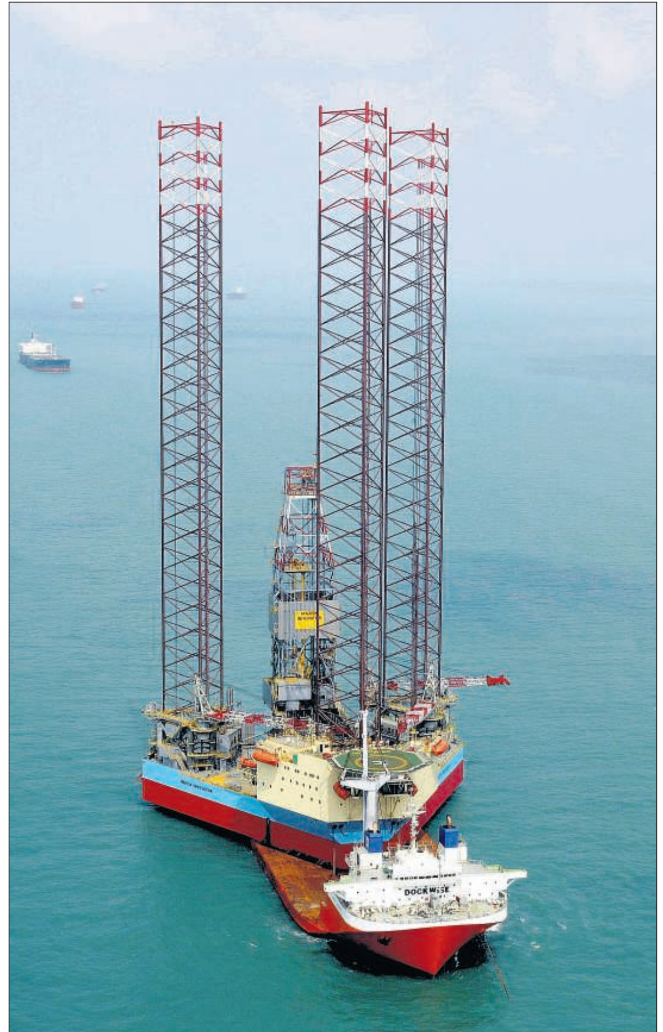
● Het grootste boorplatform dat het ingenieursbureau GustaMSC heeft ontworpen op transport.
